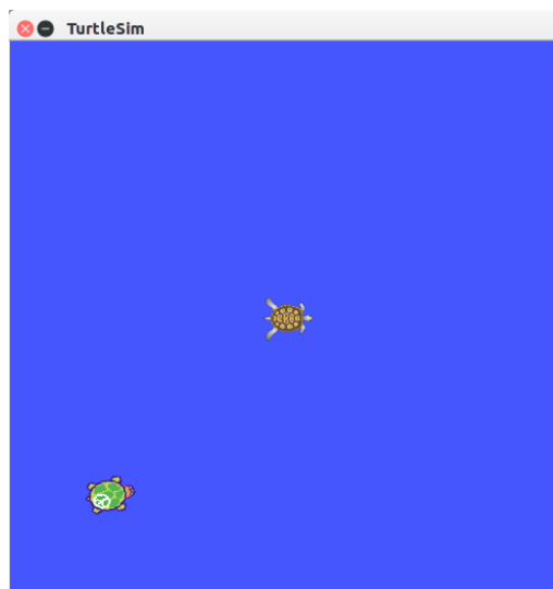
FIGURE 2.11 – Fenêtre résultat de ros2 run call /spawn turtlesim/srv/Spawn "x :0.0, y :0.0, theta : 0.0, name : 'my_turtle'"
