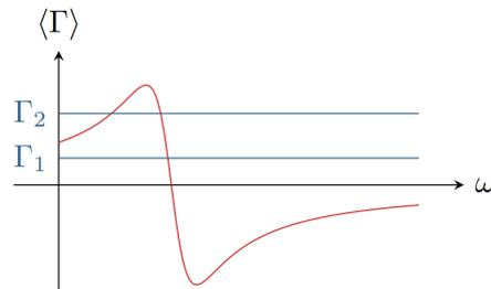
Figure 1: Points de fonctionnement du moteur asynchrone. Les points de fonctionnement sont les points d'intersection des droites bleues représentant le couple résistant et de la courbe rouge représentant le couple moteur moyen.
