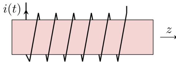
Figure 1: Dispositif de soudure inductive.
