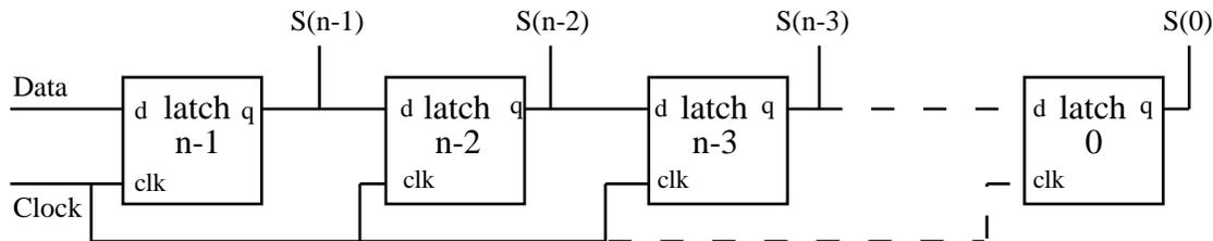
L'entrée Data permet de charger en série le registre, à chaque coup d'horloge, Clock, la donnée est décalée vers le registre suivant. La sortie est un vecteur de type **std\_logic\_vector**.
