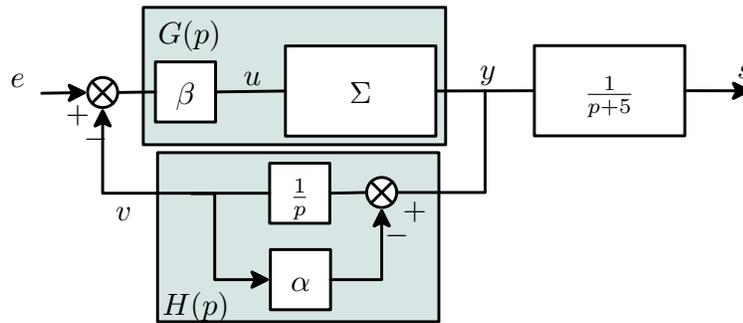
FIG. 2 – Schéma-bloc de l'asservissement du système  $\Sigma : 2\dot{y}(t) + y(t) = u(t)$
