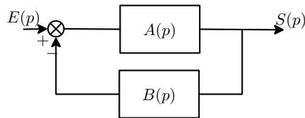
FIG. 1 – Schéma d'asservissement
