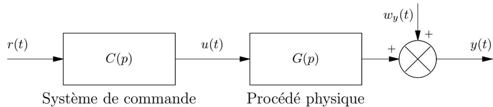
FIG. 3 – Application d'une perturbation sur la sortie du procédé pour la stratégie de commande n° I
