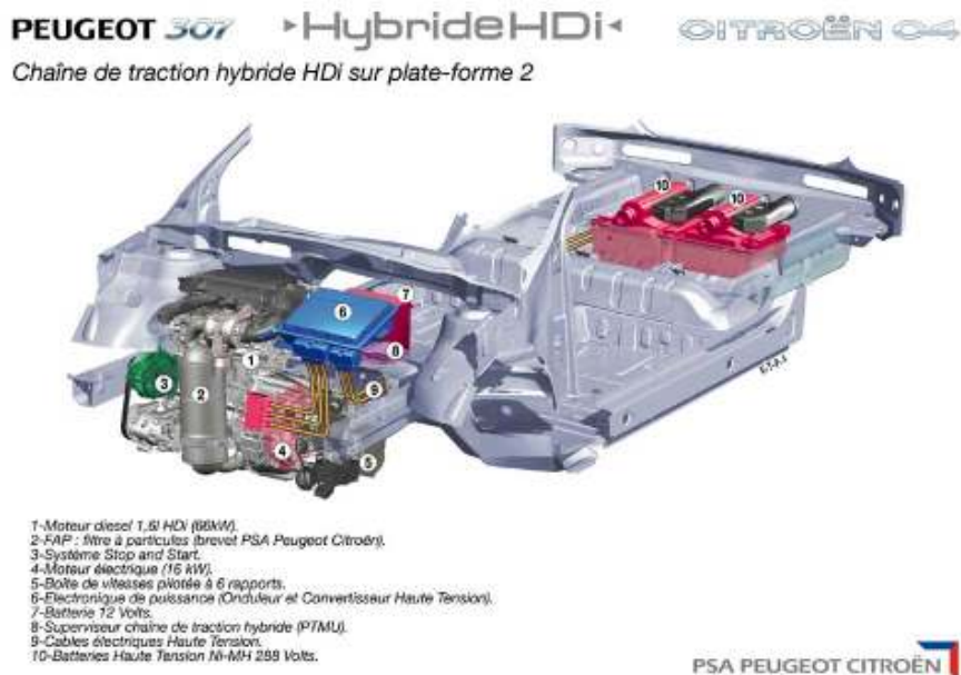
Figure : Eléments constituant le moteur hybride PSA
