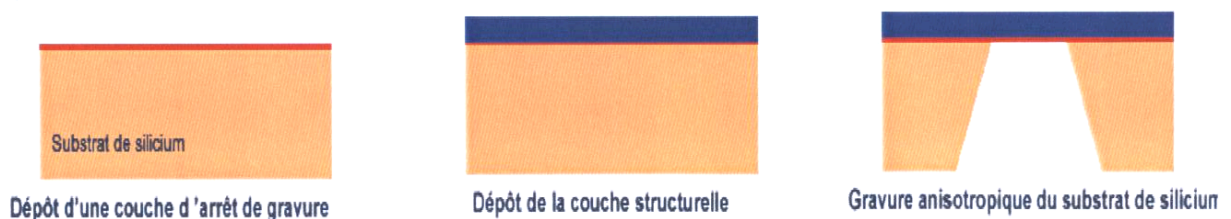
Figure 22: Principe du micro-usinage en volume.
