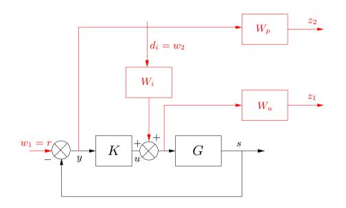
$$z = \begin{bmatrix} \mathbf{0} & W_u W_i \\ W_p & -W_p G W_i \end{bmatrix} w + \begin{bmatrix} W_u \\ -W_p G \end{bmatrix} u$$
