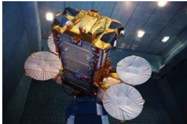
FIGURE 1.2 – Plateforme E3000 pour une mission multifaisceaux avec 4 antennes SFPB à réflecteur (tirée de [Wolf 2014])
