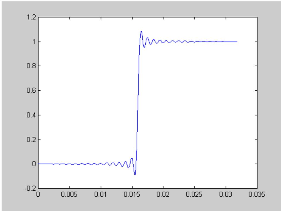
*Le filtre présente des rebonds pour tendre vers la stabilité. Il s'apparente à un filtre passe bas dont la fréquence de coupure serait 1000Hz.*
