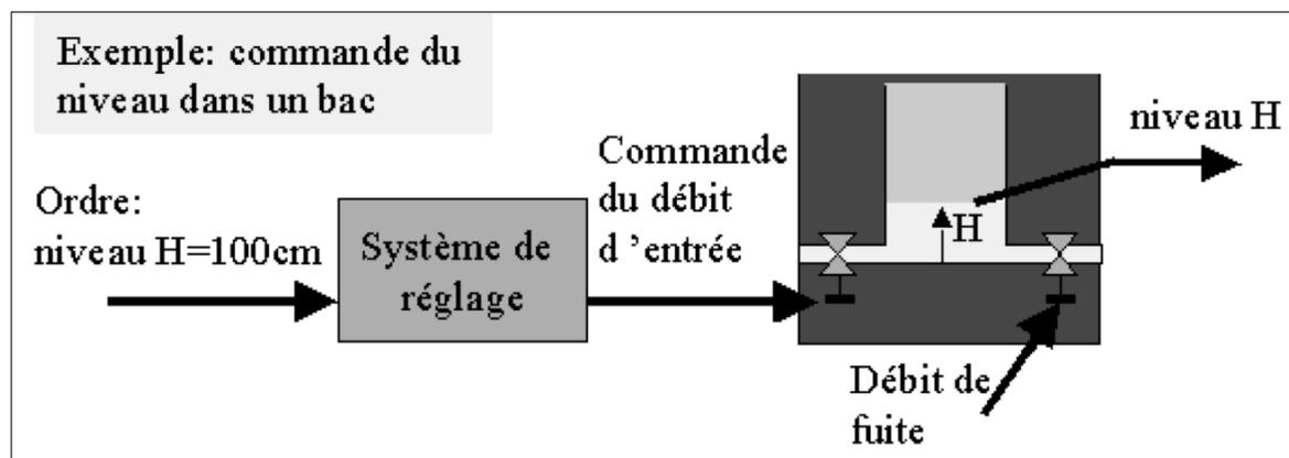
Ceci est une commande en boucle ouverte qui ne **permet pas de régler précisément le niveau** de sortie et corriger l'effet des perturbations **Commande en boucle fermée:**
