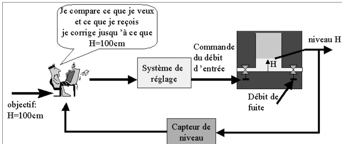
Pour régler le niveau je dois agir sur l'organe de réglage (*la vanne*) en fonction de l'écart entre la valeur désirée et la valeur réelle.
