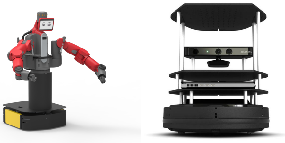
FIGURE 6.1 – Le robot Baxter en rendu 3D utilisé dans le cadre de travaux pratiques. Le robot a trois caméra au niveau de la tête, et deux dans chaque poignet.
